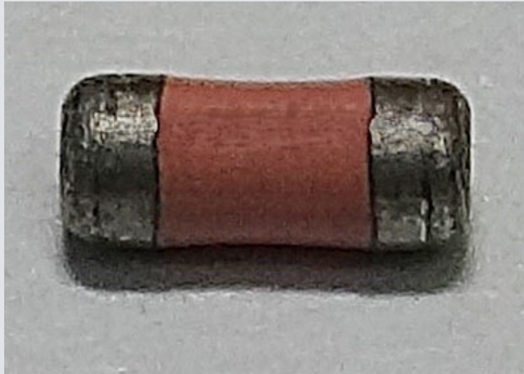
第一电阻Firstohm SRM204T (100Ω、5%)
